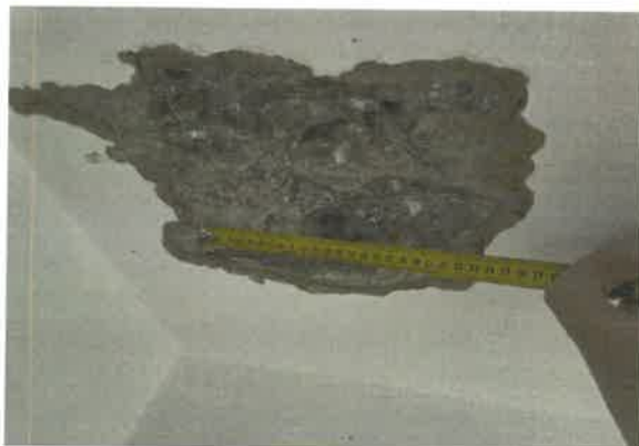
Sondaj PL01 placa beton armat monolit ax C-D,3-4, peste parter: grosime 15 cm, armare inferioară Ø10/15cm PC 52 pe direcția scurtă și Ø10/15cm PC 52 pe direcția lungă, armare superioară Ø10/15cm PC 52 pe direcția scurtă și Ø10/15cm PC 52 pe direcția lungă;
