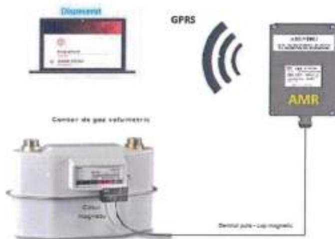
Fig. 4 - AMR pentru contoare cu membrană
